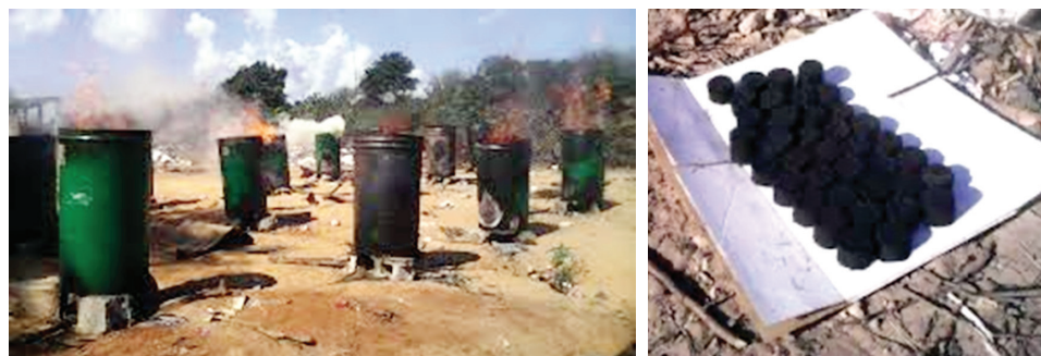
Figura 31 - Produção de biocarvão (esq.) e produto final (dir.) (foto: AMOR, 2016)
